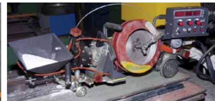
имуществ, новшеств. В сварочных установках реализована автоматическая система контроля уровня сварочной ванны, применены цифровые приборы контроля режимов сварки, современные источники питания инверторного типа, используется система управления на базе промышленного компьютера, контроллер и др.
