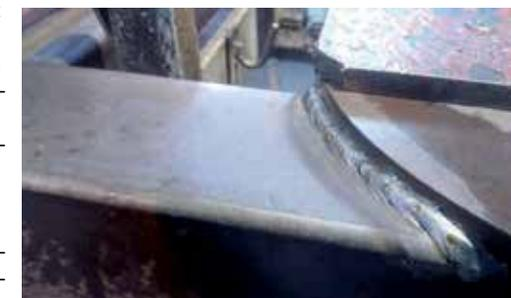
Рисунок 2. Сварочный шов с применением WBAS
