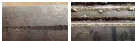
Рис. 4. Внешний вид лицевой и обратной поверхности пластин толщиной 8 мм, разрезанных в камере стенда с помощью КОПС-М порошковой проволокой ППР-АПС (разработана СПбПУ кафедрой сварки)
