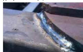
Рис. 2 Сварка без «Water based anti-spatter»
