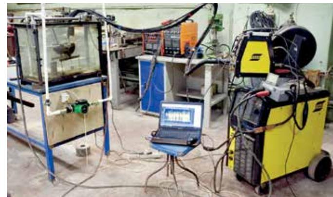
Рис. 10. Вид испытательного стенда кафедры «Теория и технология сварки материалов» ФГАОУ ВО «СПбПУ» для исследований процесса подводной мокрой автоматической резки порошковой проволокой
