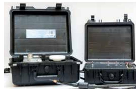
Рис. 12. Вид комплекса оборудования для механизированной подводной сварки и резки порошковой проволокой КОПС-М
