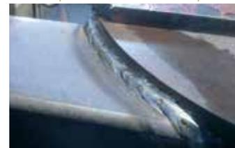
Рис. 3 Сварочный шов с применением «Water based anti-spatter»
