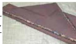
Рис. 3. Образцы, сваренный в камере стенда с помощью КОПС-М порошковой проволокой ППС-АПЛ 2 (разработана СПбПУ кафедрой сварки)
